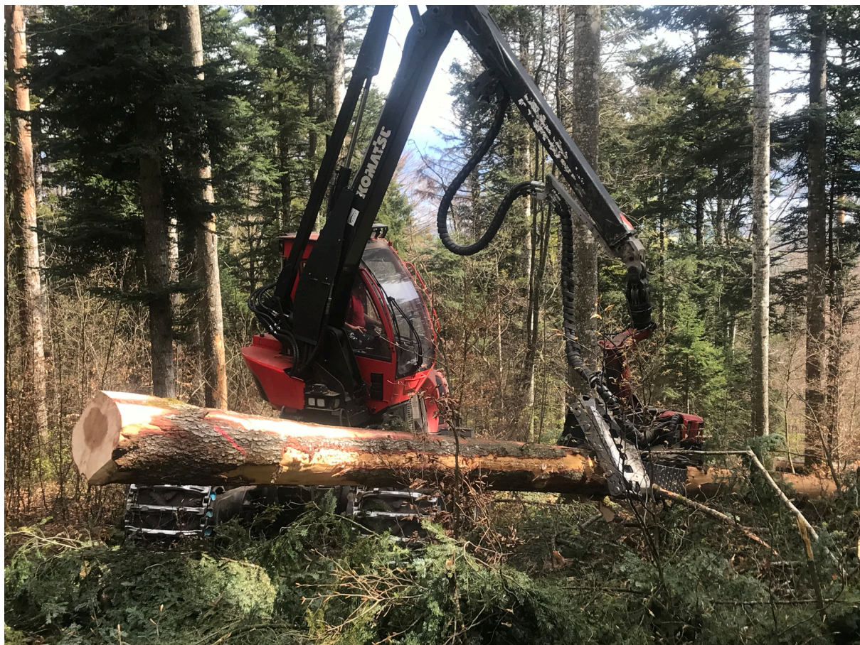
La récolteuse ébranche l'arbre abattu (source : Allan Pellaton)
