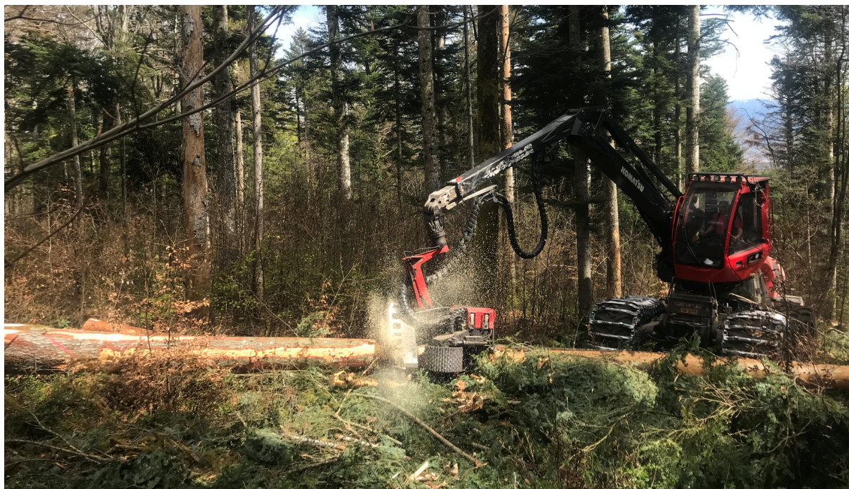
Une fois à la bonne longueur, le billon est débité (source : Allan Pellaton)
